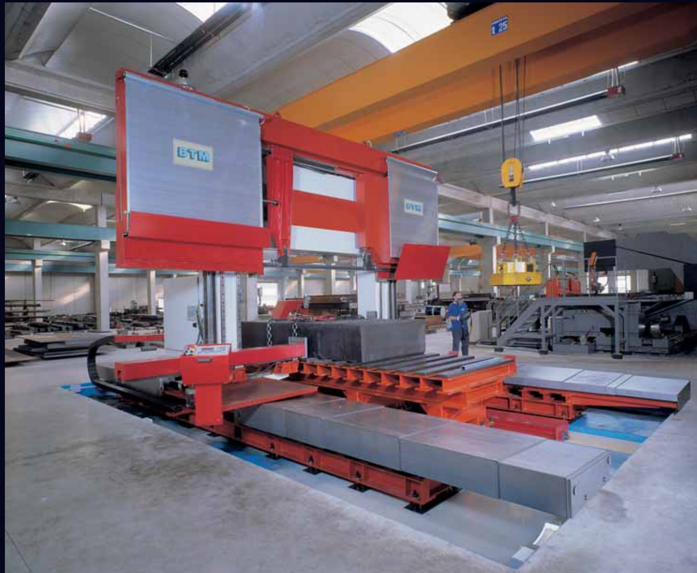
mod. 1600 CNC mod. 2000 CNC Gruppo di taglio traslabile: corsa 6000 mm. Sliding cutting unit: sliding length up to 6000 mm.
