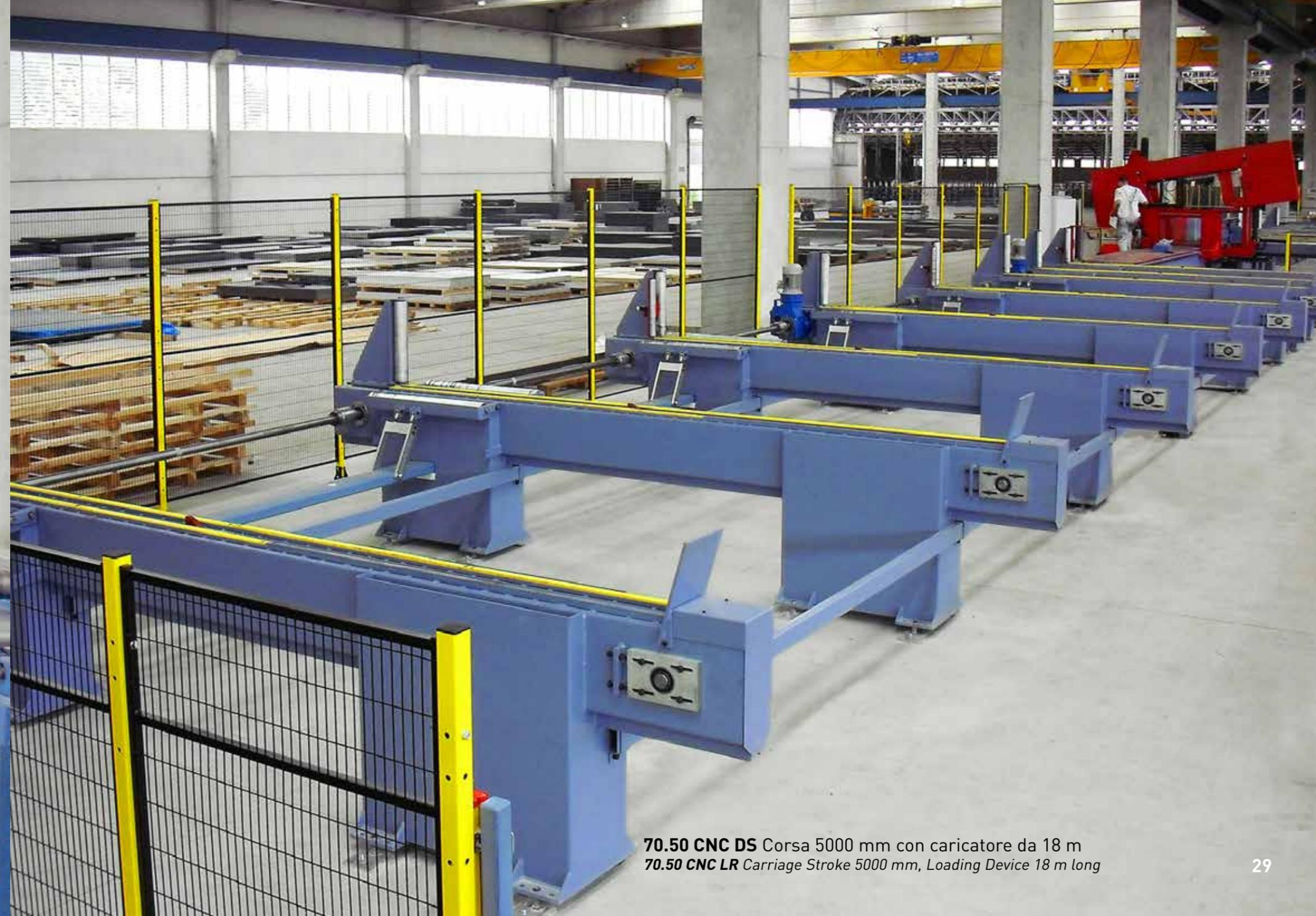
**70.50 CNC DS** Corsa 5000 mm con caricatore da 18 m
