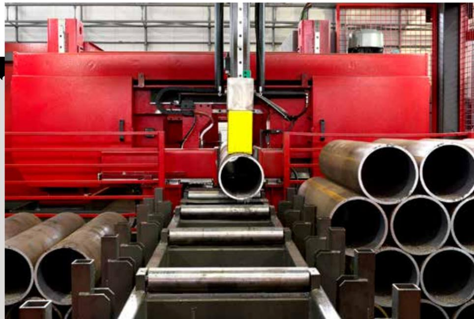
420 CNC Touch Testa coda con caricatore e manipolatore di scarico
