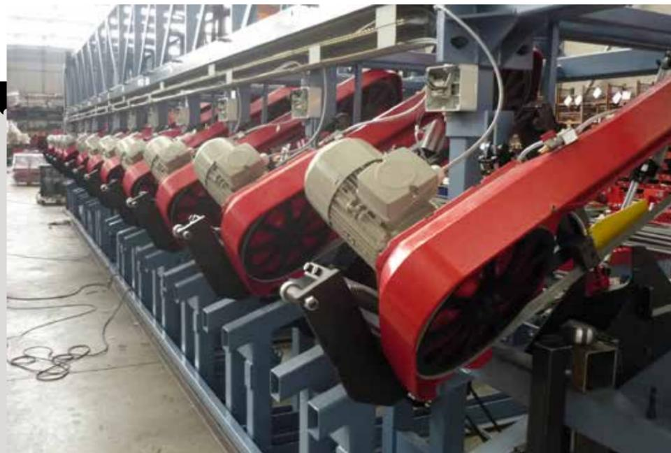
11 teste automatiche per taglio tiranti  $\varnothing$  10-120 mm da 1 a 12 m
