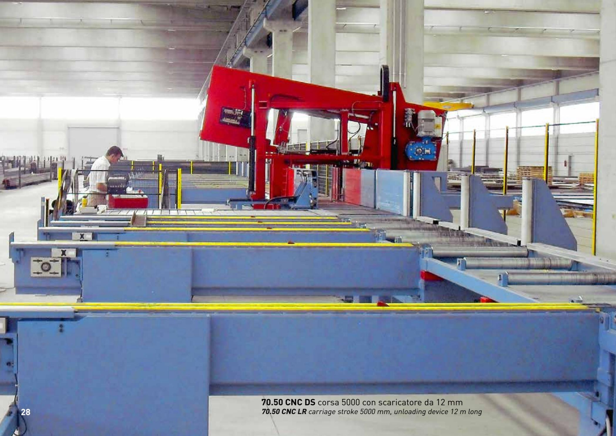
**70.50 CNC DS** corsa 5000 con scaricatore da 12 m
