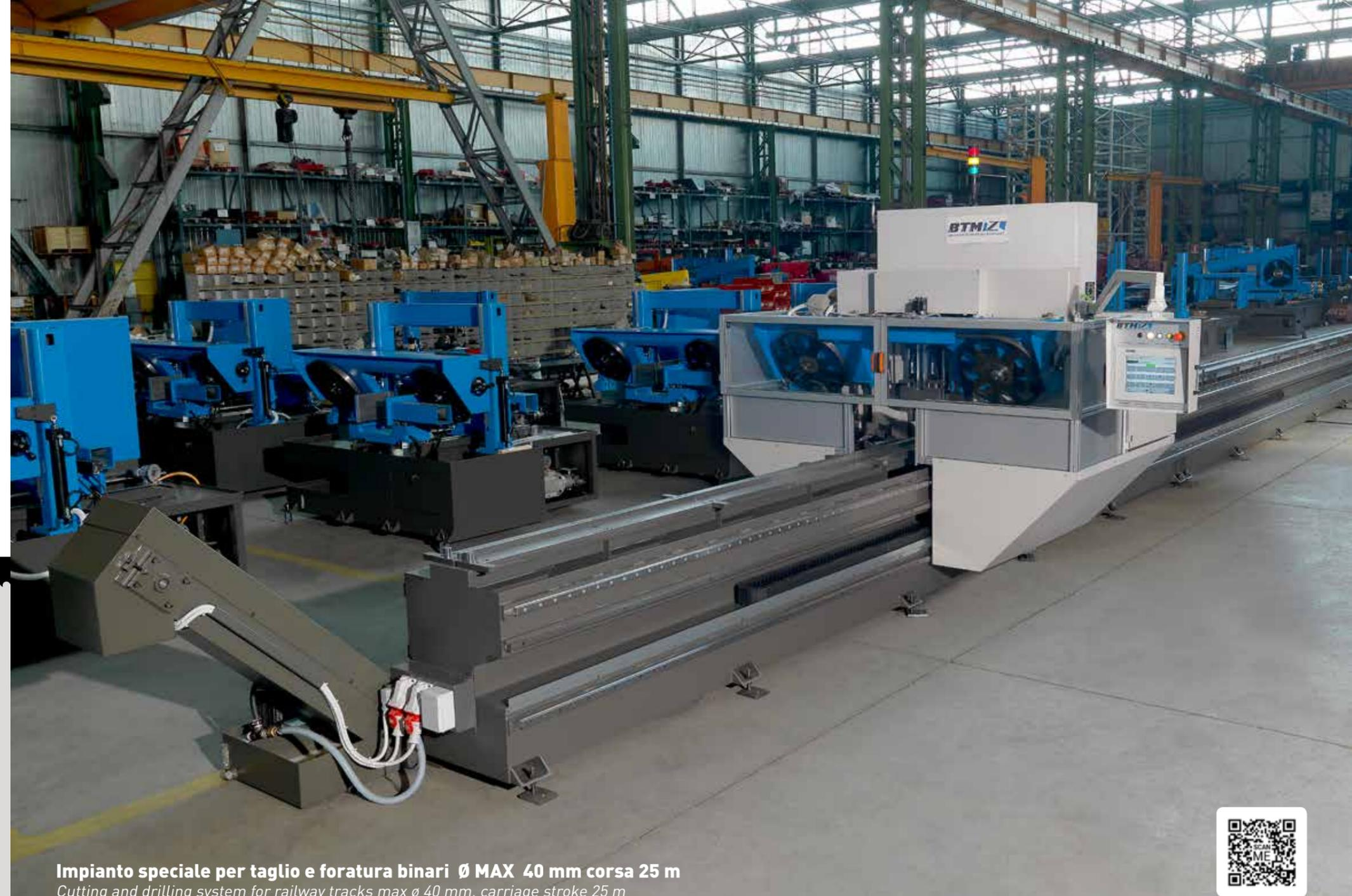
**Impianto speciale per taglio e foratura binari Ø MAX 40 mm corsa 25 m**
