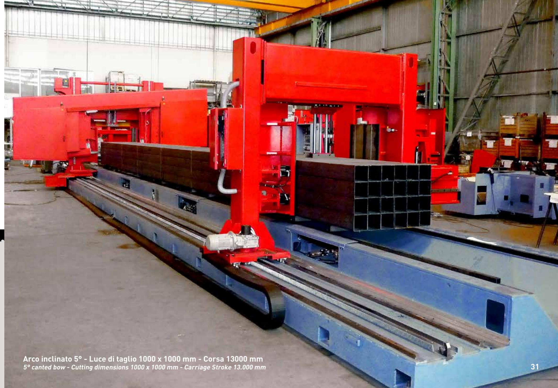
Arco inclinato 5° - Luce di taglio 1000 x 1000 mm - Corsa 13000 mm
