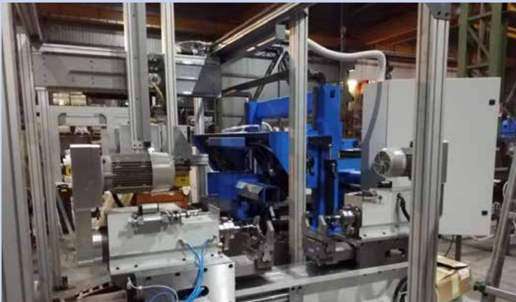
Impianto speciale per taglio, centratura e marcatura alberi Special system for shaft, cutting, marking
