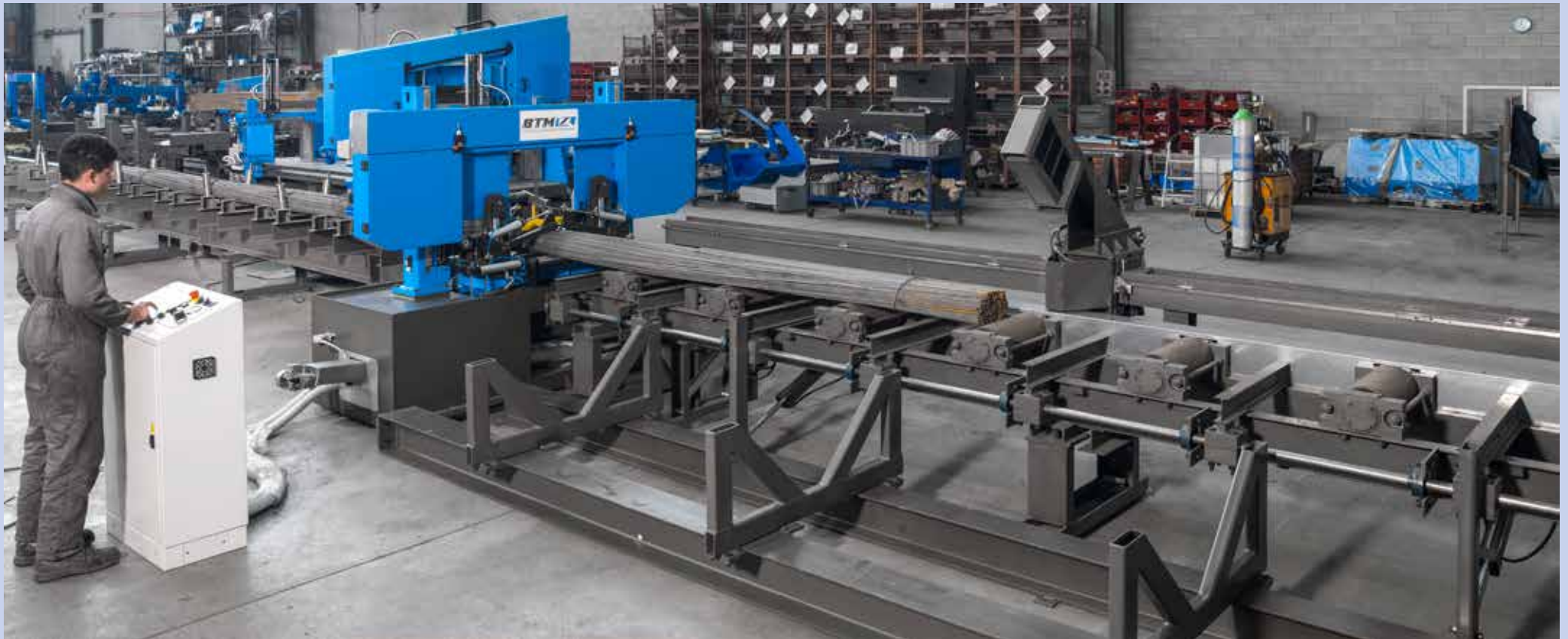
TT 350 segatrice speciale per taglio tondini TT 350 segatrice speciale per taglio tondini
