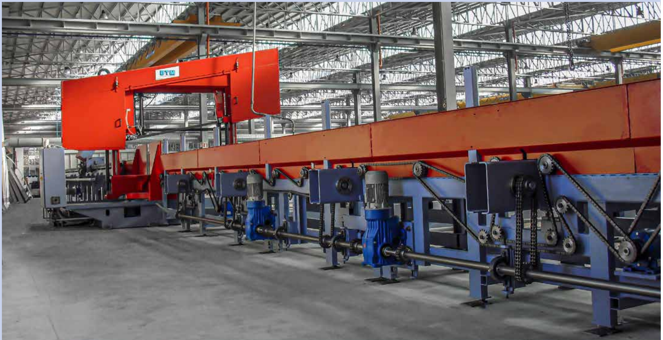
AT 12.7 SA DS con rulliera motorizzata, caricatore e scaricatore AT 12.7 SA DS with powered roller track, loading and unloading unit
