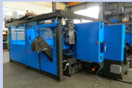
AT 440 TC corsa carro 1500 mm con caricatore e scaricatore AT 440 TC carriage stroke 1500 mm with loading and unloading unit
