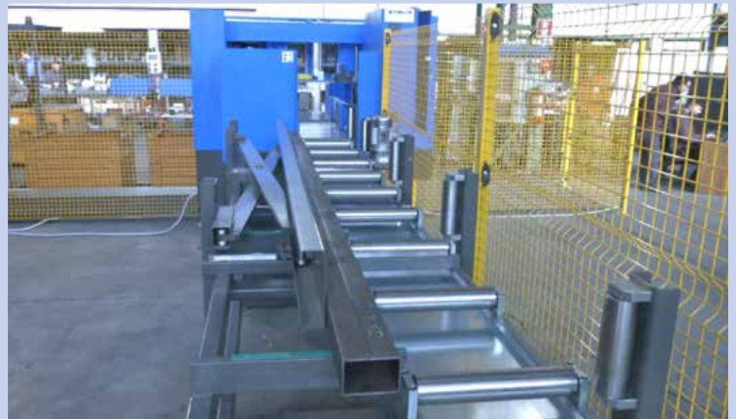
360 TCT con caricatore a una posizione 360 TCT with single station loading device
