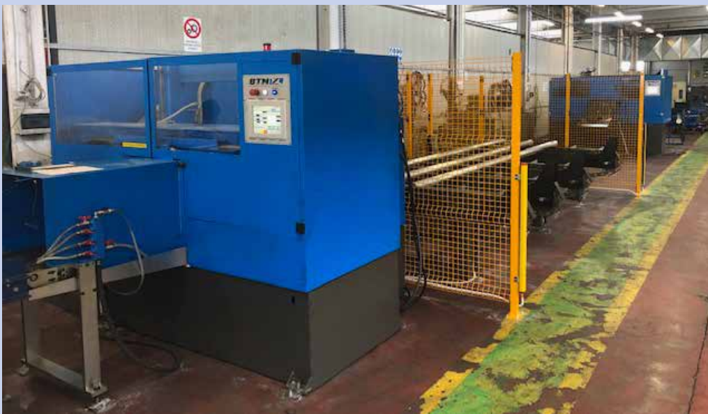
AT 460 TC per taglio alluminio con caricatore AT 460 TC aluminium cutting with loading
