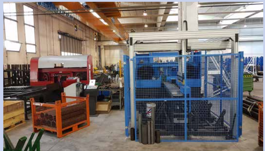
Impianto speciale per tubi e cromati con pulizia tubo interno. Caricatore da 12 m. Special system for tubes and chromes cutting with internal cleaning. 12 m loading device
