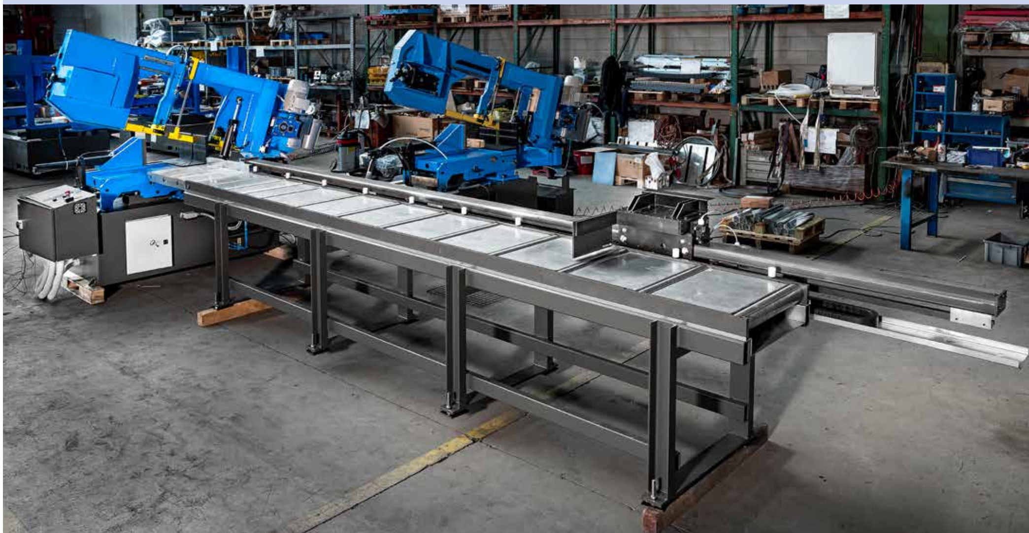
AP 5.5 SA DS con rulliera in uscita e riscontro AP 5.5 SA DS with outfeed roller track and length stop
