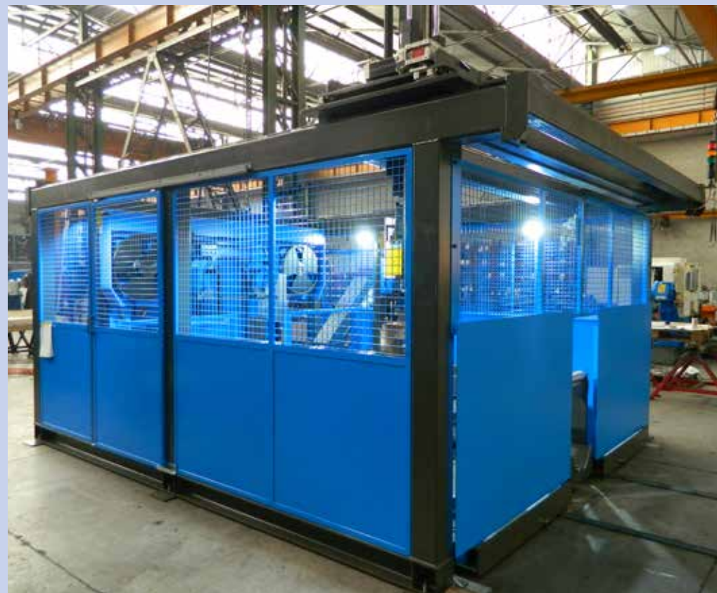
AT 440 TC corsa carro 1500 mm con caricatore e scaricatore AT 440 TC carriage stroke 1500 mm with loading and unloading unit
